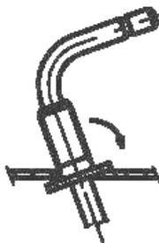
3. Montáž dokončit nasazením těsnění, podložky a dotažením matice.
